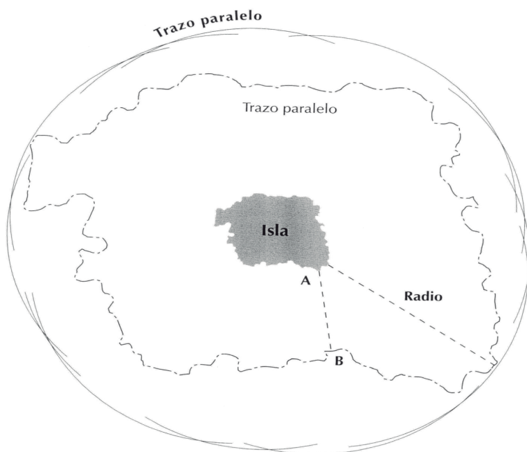
Gráfica 8. Delimitación del límite exterior del mar territorial de una isla mediante el método de trazado paralelo y del método de arcos de circunferencia.
